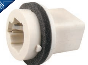
DP3.044 Soquete Pisca Adaptação (1 Pólo) Universal Gol / Parati / Saveiro / Santana / Voyage / Passat / Monza / Chevette / Opala / Vectra / Caravan / Corsa / Pick-Up / Kadett / Patio / Tempra / Escort / Apollo / Corcel / Belina / Courier.
